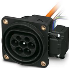
CHARX connect universal, AC Typ 2, Fahrzeug-Ladedose, 32 A , 250 V AC, Einzelladern, Länge: 2 m, Verriegelungsaktuator: 24 V, 4-polig, Vorder- und Rückwandmontage, M6, Gehäuse: schwarz, zum Laden mit Wechselstrom (AC) von Elektrofahrzeugen (EV), IEC 62196-2, Für die AC-Kontakte ist eine Schutzkappe im Lieferumfang enthalten.
