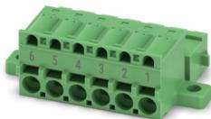
Leiterplattenstecker, Nennquerschnitt: 2,5 mm<sup>2</sup>, Farbe: grün, Nennstrom: 12 A, Bemessungsspannung (III/2): 320 V, Kontaktobерfläche: Sn, Kontaktart: Stift, Anzahl der Reihen: 1, Polzahl: 6, Artikelfamilie: FKICS 2,5/..-STD-RN, Rastermaß: 5,08 mm, Anschlussart: Push-in-Federanschluss, Anschlussrichtung Leiter/Platine: 0 °, Rasthaken: - ohne Rasthaken, Stecksystem: COMBICON MSTB 2,5, Verriegelung: Rastverriegelung, Befestigungsart: Rastnase, Verpackungsart: verpackt im Karton
