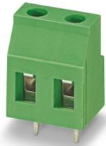
Leiterplattenklemme, Nennstrom: 24 A, Bemessungsspannung (III/2): 630 V, Nennquerschnitt: 2,5 mm<sup>2</sup>, Anzahl der Reihen: 1, Polzahl pro Reihe: 2, Artikelfamilie: GMKDS 3, Rastermaß: 7,5 mm, Anschlussart: Schraubanschluss mit Zughülse, Schraubenangriffsform: L Längsschlitz, Montage: Wellenlöten, Anschlussrichtung Leiter/Platine: 0 °, Farbe: grün, Pin-Layout: Lineares Pinning, Pinlänge [P]: 5,1 mm, Anzahl der Lötpins pro Potenzial: 1, Verpackungsart: verpackt im Karton
