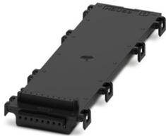
Tragschienen-Busverbinder, Farbe: schwarz, Nennstrom: 3 A (je Kontakt), Bemessungsspannung (III/2): 100 V, Polzahl: 8, Artikelfamilie: BC 107,6..., Rastermaß: 2,54 mm, Montage: Tragschienenmontage, Verriegelung: ohne
