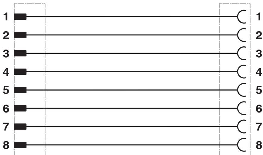
Kontaktbelegung der M8-Stecker/Buchse
