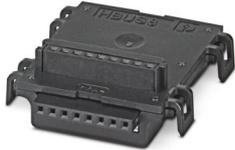
Tragschienen-Busverbinder, Farbe: schwarz, Nennstrom: 3 A (je Kontakt), Bemessungsspannung (III/2): 100 V, Anzahl der Potenziale: 8, Polzahl: 8, Artikelfamilie: BC 35,6..., Rastermaß: 2,54 mm, Montage: Tragschienenmontage, Verriegelung: ohne
