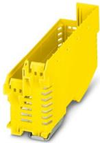
Tragschienengehäuse, Gehäuseunterteil mit Metallfußriegel, mit Lüftungsschlitzen, Breite: 37,89 mm, Höhe: 120,6 mm, Tiefe: 64,3 mm, Farbe: gelb (ähnlich RAL 1018), Querverbindung: Tragschienen-Busverbinder (optional), Polzahl Querverbinder: 5 oder 8
