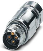
Kupplungssteckverbinder, gerade, für Standard- und SPEEDCON-Verriegelung, M17, Polzahl: 6+PE, Kontaktart: Buchse, geschirmt: ja, Schutzart: IP67, Kabeldurchmesserbereich: 10 mm ... 12,5 mm, Polzahl: 7, Anschlussart: Crimpanschluss, Serie: ST, Artikel ist bleifrei nach RoHS II ohne Ausnahme 6c (Pb < 0,1 %)
