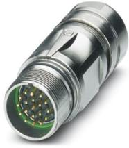
M23, Kupplungssteckverbinder, Serie: CA, gerade, geschirmt: ja, für Standard- und SPEEDCON-Verriegelung, Polzahl: 16+2+FE, Drehsinn: Standard, Kontaktart: Stift, Crimpanschluss, Kabeldurchmesserbereich: 10 mm ... 14,5 mm, Kodierung: N, Artikel ist bleifrei nach RoHS II ohne Ausnahme 6c (Pb < 0,1 %)
