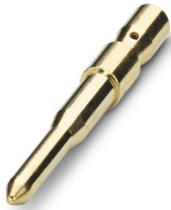
Crimpkontakt, Stift, voreilend, gedreht, Kontaktdurchmesser: 1,5 mm, Anschlussquerschnitt: 0,75 mm<sup>2</sup> ... 1 mm<sup>2</sup>, Material Kontakt: CuZn, Artikel ist bleifrei nach RoHS II ohne Ausnahme 6c (Pb < 0,1 %)
