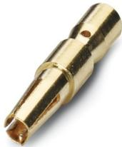
Crimpkontakt, Buchse, gedreht, Kontaktdurchmesser: 1,5 mm, Anschlussquerschnitt: 0,75 mm<sup>2</sup> .. 1 mm<sup>2</sup>, Material Kontakt: CuZn, Artikel ist bleifrei nach RoHS II ohne Ausnahme 6c (Pb < 0,1 %)
