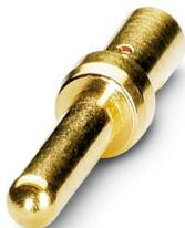
Crimpkontakt, Stift, gedreht, Kontaktdurchmesser: 1 mm, Anschlussquerschnitt: 0,75 mm<sup>2</sup> ... 1 mm<sup>2</sup>, Material Kontakt: CuZn, Artikel ist bleifrei nach RoHS II ohne Ausnahme 6c (Pb < 0,1 %)
