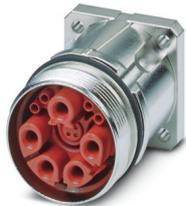
M40, Gerätesteckverbinder Vorderwand, Serie: SB, gerade, geschirmt: ja, für Standard- und SPEEDCON-Verriegelung, Polzahl: 8+4+PE, Kontaktart: Buchse, Crimpanschluss, O-Ring axial, Flanschmaß: 40 mm x 40 mm, Kodierung: Signal, Kodierung 1, Artikel ist bleifrei nach RoHS II ohne Ausnahme 6c (Pb < 0,1 %)
