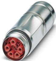
M40, Kupplungssteckverbinder, Serie: SB, gerade lang, geschirmt: ja, für Standard- und SPEEDCON-Verriegelung, Polzahl: 4+4+4+PE / 3+N+PE, Kontaktart: Buchse, Crimpanschluss, Kabeldurchmesserbereich: 14 mm ... 20,5 mm, Kodierung: CAT5, Kodierung 1, Artikel ist bleifrei nach RoHS II ohne Ausnahme 6c (Pb < 0,1 %)
