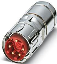
M40, Kabelsteckverbinder, Serie: SB, gerade lang, geschirmt: ja, SPEEDCON, Polzahl: 8+4+PE, Kontaktart: Stift, Crimpanschluss, Kabeldurchmesserbereich: 14 mm ... 20,5 mm, Kodierung: Signal, Kodierung 1, Artikel ist bleifrei nach RoHS II ohne Ausnahme 6c (Pb < 0,1 %)
