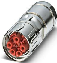
M40, Kabelsteckverbinder, Serie: SB, gerade lang, geschirmt: ja, SPEEDCON, Polzahl: 4+4+4+PE / 3+N+PE, Kontaktart: Buchse, Crimpanschluss, Kabeldurchmesserbereich: 14 mm .. 20,5 mm, Kodierung: CAT5, Kodierung 1, Artikel ist bleifrei nach RoHS II ohne Ausnahme 6c (Pb < 0,1 %)
