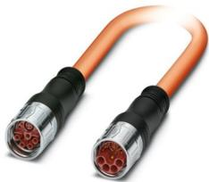
Steckverbinder beidseitig kunststoffumspritzt, Serie: KSH, M23-Buchse, gerade kunststoffumspritzt, Polzahl: 4+4+4+PE, Verriegelungsart: SPEEDCON, auf M23-Stift, gerade kunststoffumspritzt, Polzahl: 4+4+4+PE, Verriegelungsart: SPEEDCON, Kabellänge: 10 m, geschirmt: ja, Farbe Außenmantel: orange RAL 2003, Artikel ist bleifrei nach RoHS II ohne Ausnahme 6c (Pb < 0,1 %)
