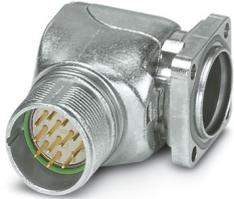
M23, Gerätesteckverbinder Vorderwand, Serie: CA, gewinkelt drehbar, geschirmt: ja, für Standard- und SPEEDCON-Verriegelung, Polzahl: 17, Drehsinn: Standard, Kontaktart: Stift, Lötanschluss, O-Ring axial, Kodierung: N, Artikel ist bleifrei nach RoHS II ohne Ausnahme 6c (Pb < 0,1 %)
