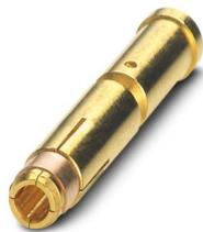
Crimpkontakt, Buchse, gedreht, Kontaktdurchmesser: 2 mm, Anschlussquerschnitt: 0,25 mm<sup>2</sup> ... 2,5 mm<sup>2</sup>, Material Kontakt: CuZn, Artikel ist bleifrei nach RoHS II ohne Ausnahme 6c (Pb < 0,1 %)
