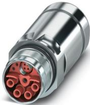
M23, Kupplungssteckverbinder, Serie: SH, gerade lang, geschirmt: ja, für Standard- und SPEEDCON-Verriegelung, Polzahl: 4+4+4+PE / 3+N+PE, Kontaktart: Buchse, Crimpanschluss, Kabeldurchmesserbereich: 9 mm ... 12 mm, Artikel ist bleifrei nach RoHS II ohne Ausnahme 6c (Pb < 0,1 %)
