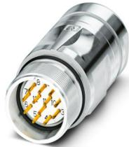
M23, Kupplungssteckverbinder, Serie: CA, gerade, geschirmt: ja, für Standard- und SPEEDCON-Verriegelung, Polzahl: 17, Drehsinn: Standard, Kontaktart: Stift, Lötanschluss, Kabeldurchmesserbereich: 3 mm ... 14,5 mm, Kodierung: N, Artikel ist bleifrei nach RoHS II ohne Ausnahme 6c (Pb < 0,1 %)
