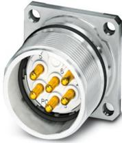
M23, Gerätesteckverbinder Vorderwand, Serie: CA, gerade, geschirmt: ja, für Standard- und SPEEDCON-Verriegelung, Polzahl: 8+1, Drehsinn: Standard, Kontaktart: Stift, Lötanschluss, Flachdichtung, Flanschmaß: 25 mm x 25 mm, Kodierung: N, Artikel ist bleifrei nach RoHS II ohne Ausnahme 6c (Pb < 0,1 %)
