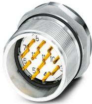
M23, Gerätesteckverbinder Vorderwand, Serie: CA, gerade, geschirmt: ja, für Standard- und SPEEDCON-Verriegelung, Polzahl: 12, Drehsinn: Standard, Kontaktart: Stift, Lötkehl, Axialdichtung, Kodierung: N, Artikel ist bleifrei nach RoHS II ohne Ausnahme 6c (Pb < 0,1 %)
