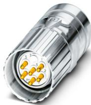
M23, Kabelsteckverbinder, Serie: CA, gerade, geschirmt: ja, Schraubverriegelung, Polzahl: 7, Drehsinn: Standard, Kontaktart: Stift, Crimpanschluss, Kabeldurchmesserbereich: 3 mm ... 14,5 mm, Kodierung: N, Artikel ist bleifrei nach RoHS II ohne Ausnahme 6c (Pb < 0,1 %)
