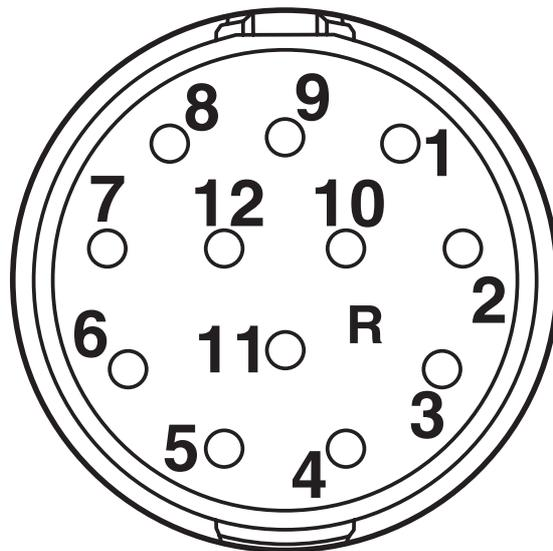
Kontaktkammernummerierung (Ansicht Steckseite) Buchse Gegenlauf
