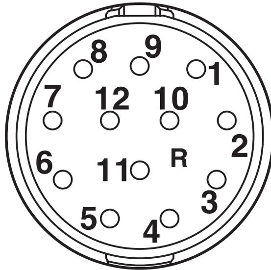
Kontaktkammernummerierung (Ansicht Steckseite) Buchse Gegenlauf
