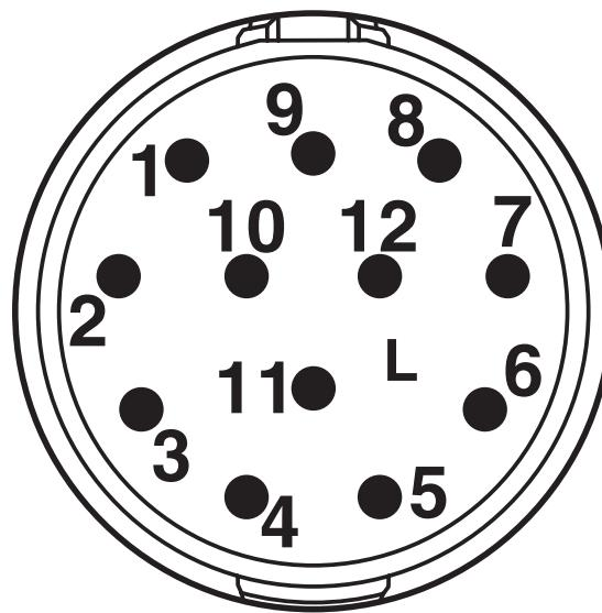
Kontaktkammernumerierung (Ansicht Steckseite) Stift Gegenlauf
