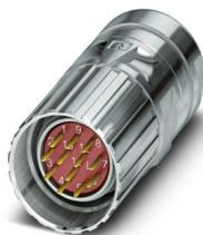
M23, Kabelsteckverbinder, Serie: CA, gerade, geschirmt: ja, Schraubverriegelung, Polzahl: 12, Drehsinn: Gegenlauf, Kontaktart: Stift, Crimpanschluss, Kabeldurchmesserbereich: 6 mm ... 10 mm, Kodierung: N, Artikel ist bleifrei nach RoHS II ohne Ausnahme 6c (Pb < 0,1 %)
