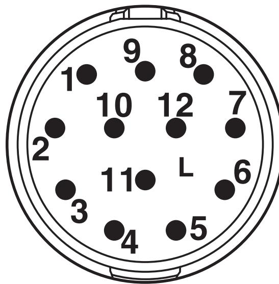
Kontaktkammernumerierung (Ansicht Steckseite) Stift Gegenlauf
