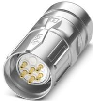
M23, Kabelsteckverbinder, Serie: CA, gerade, geschirmt: ja, SPEEDCON, Polzahl: 6, Drehsinn: Standard, Kontaktart: Stift, Crimpanschluss, Kabeldurchmesserbereich: 3 mm ... 14,5 mm, Kodierung: N, Artikel ist bleifrei nach RoHS II ohne Ausnahme 6c (Pb < 0,1 %)
