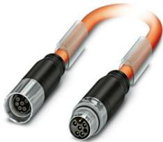
Steckverbinder beidseitig kunststoffumspritzt, Serie: KST, M17-Buchse, gerade kunststoffumspritzt, Polzahl: 5+PE, Verriegelungsart: Schraubverriegelung, auf M17-Stift, gerade kunststoffumspritzt, Polzahl: 5+PE, Kabellänge: 10 m, geschirmt: ja, Artikel ist bleifrei nach RoHS II ohne Ausnahme 6c (Pb < 0,1 %)
