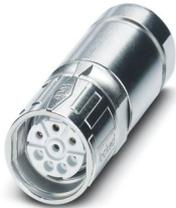
Kabelsteckverbinder, gerade lang, SPEEDCON, M23, Polzahl: 5+PE, Kontaktart: Buchse, geschirmt: ja, Schutzart: IP67, Kabeldurchmesserbereich: 9 mm ... 12 mm, Polzahl: 6, Anschlussart: Crimpanschluss, Serie: SF, Artikel ist bleifrei nach RoHS II ohne Ausnahme 6c (Pb < 0,1 %)
