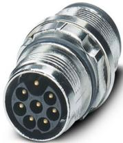
Gerätesteckverbinder Vorderwand, gerade, für Standard- und SPEEDCON-Verriegelung, M17, Polzahl: 6+PE, Kontaktart: Stift, O-Ring axial, geschirmt: ja, Polzahl: 7, Anschlussart: Crimpanschluss, Serie: ST, Artikel ist bleifrei nach RoHS II ohne Ausnahme 6c (Pb < 0,1 %), Dieses Produkt befindet sich in einem Abkündigungsprozess. Für neue Projekte darf dieses Produkt nicht mehr berücksichtigt werden. Bitte wenden Sie sich für Alternativen an Ihren zuständigen Vertriebsmitarbeiter.
