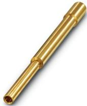
Crimpkontakt, Buchse, gedreht, Kontaktdurchmesser: 1,6 mm, Anschlussquerschnitt: 0,34 mm<sup>2</sup> .. 1,5 mm<sup>2</sup>, Material Kontakt: CuZn, Artikel ist bleifrei nach RoHS II ohne Ausnahme 6c (Pb < 0,1 %)
