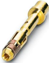
Crimpkontakt, Buchse, gedreht, Kontaktdurchmesser: 1 mm, Anschlussquerschnitt: 0,06 mm<sup>2</sup> ... 1 mm<sup>2</sup>, Material Kontakt: CuZn, Artikel ist bleifrei nach RoHS II ohne Ausnahme 6c (Pb < 0,1 %)
