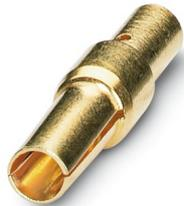
Crimpkontakt, Buchse, gedreht, Kontaktdurchmesser: 2 mm, Anschlussquerschnitt: 0,06 mm<sup>2</sup> ... 1 mm<sup>2</sup>, Material Kontakt: CuZn, Artikel ist bleifrei nach RoHS II ohne Ausnahme 6c (Pb < 0,1 %)
