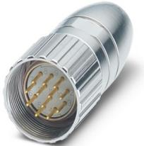
M23, Kabelsteckverbinder, gerade, Schraubverriegelung, Polzahl: 16, Drehsinn: Standard, Kontaktart: Stift, Lötkehl, Kabeldurchmesserbereich: 3 mm ... 10,5 mm, Kodierung: N, Artikel ist bleifrei nach RoHS II ohne Ausnahme 6c (Pb < 0,1 %)
