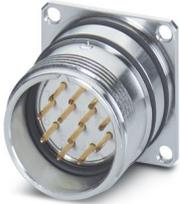
M23, Gerätesteckverbinder Hinterwand, Serie: RC, gerade, Schraubverriegelung, Polzahl: 12, Drehsinn: Standard, Kontaktart: Stift, Lötkelch, O-Ring radial, Wandstärke min.: 2,7 mm, Wandstärke max.: 3,5 mm, Kodierung: N, Artikel ist bleifrei nach RoHS II ohne Ausnahme 6c (Pb < 0,1 %)
