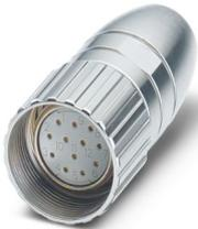
M23, Kabelsteckverbinder, gerade, Schraubverriegelung, Polzahl: 6, Drehsinn: Standard, Kontaktart: Buchse, Crimpanschluss, Kabeldurchmesserbereich: 3 mm ... 10,5 mm, Kodierung: N, Artikel ist bleifrei nach RoHS II ohne Ausnahme 6c (Pb < 0,1 %)
