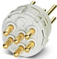
Kontakteinsatz, gerade, M23, Polzahl: 6, Kontaktart: Stift, Einlötlanschluss, Serie: RC, TU, Artikel ist bleifrei nach RoHS II ohne Ausnahme 6c (Pb < 0,1 %)
