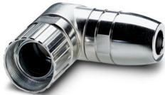
Gehäuse für Rundsteckverbinder, Serie: RC, gewinkelt, Schraubverriegelung, M23, Polzahl: 12, Kontaktart: Buchse, Crimpanschluss, geschirmt: ja, Kabeldurchmesserbereich: 2 mm... 10,5 mm, Artikel ist bleifrei nach RoHS II ohne Ausnahme 6c (Pb < 0,1 %). Dieses Produkt befindet sich in einem Abkündigungsprozess. Für neue Projekte darf dieses Produkt nicht mehr berücksichtigt werden. Bitte wenden Sie sich für Alternativen an Ihren zuständigen Vertriebsmitarbeiter.
