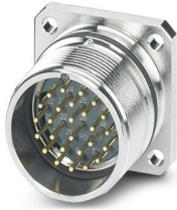
Gerätesteckverbinder Vorderwand, gerade, Schraubverriegelung, M27, Polzahl: 28, Kontaktart: Stift, O-Ring radial, geschirmt: ja, Polzahl: 28, Anschlussart: Lötkech, Serie: HC, Artikel ist bleifrei nach RoHS II ohne Ausnahme 6c (Pb < 0,1 %)
