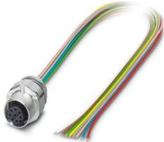
Gerätesteckverbinder Vorderwand, Universal, 8-polig, Buchse, gerade, M12-SPEEDCON, A-Kodierung, auf freies Leitungsende, Einzellitzen, Kabellänge: 1 m, 0,25 mm<sup>2</sup>, TPE-Litze, vergossen, Artikel ist bleifrei nach RoHS II ohne Ausnahme 6c (Pb < 0,1 %)
