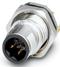
Gerätesteckverbinder Hinterwand, 5-polig, Stift, gerade, M12-SPEEDCON, B-Kodierung, Lötstifte, Artikel ist bleifrei nach RoHS II ohne Ausnahme 6c (Pb < 0,1 %)
