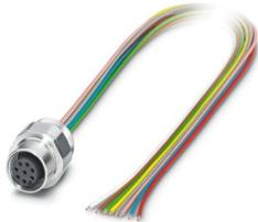
Gerätesteckverbinder Vorderwand, Universal, 8-polig, Buchse, gerade, M12-Standard, A-Kodierung, auf freies Leitungsende, Einzellitzen, Kabellänge: 0,5 m, 0,25 mm<sup>2</sup>, TPE-Litze, vergossen, Artikel ist bleifrei nach RoHS II ohne Ausnahme 6c (Pb < 0,1 %)
