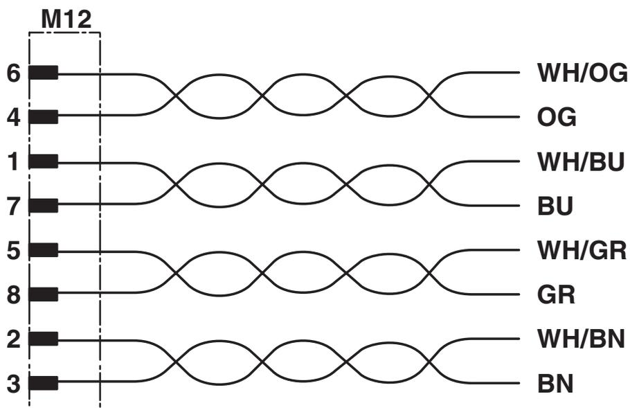
Kontaktbelegung des M12-Stecker und der M12-Buchse
