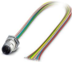
Gerätesteckverbinder Hinterwand, Universal, 8-polig, Stift, gerade, M12-SPEEDCON, A-Kodierung, auf freies Leitungsende, Einzellitzen, Kabellänge: 0,5 m, 0,25 mm<sup>2</sup>, TPE-Litze, vergossen, Artikel ist bleifrei nach RoHS II ohne Ausnahme 6c (Pb < 0,1 %)
