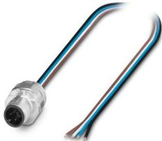
Gerätesteckverbinder Vorderwand, Universal, 4-polig, Stift, gerade, M12-SPEEDCON, A-Kodierung, auf freies Leitungsende, Einzellitzen, Kabellänge: 0,5 m, 0,34 mm<sup>2</sup>, TPE-Litze, vergossen, Artikel ist bleifrei nach RoHS II ohne Ausnahme 6c (Pb < 0,1 %)
