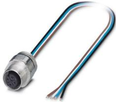
Gerätesteckverbinder Vorderwand, Universal, 4-polig, Buchse, gerade, M12-Standard, A-Kodierung, auf freies Leitungsende, Einzellitzen, Kabellänge: 1,5 m, 0,34 mm<sup>2</sup>, TPE-Litze, vergossen, Artikel ist bleifrei nach RoHS II ohne Ausnahme 6c (Pb < 0,1 %)
