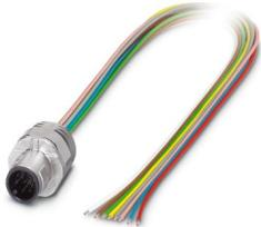
Gerätesteckverbinder Vorderwand, 8-polig, Stift, gerade, M12-SPEEDCON, A-Kodierung, auf freies Leitungsende, Einzellitzen, Kabellänge: 2 m, 0,25 mm<sup>2</sup>, TPE-Litze, vergossen, Artikel ist bleifrei nach RoHS II ohne Ausnahme 6c (Pb < 0,1 %)
