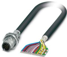
Gerätesteckverbinder Hinterwand, Universal, 17-polig, PVC/PVC, schwarz RAL 9005, geschirmt, Stift, gerade, M12-SPEEDCON, A-Kodierung, auf freies Leitungsende, Kabelanschluss, Kabellänge: 1 m, 0,14 mm<sup>2</sup>, PVC schwarz, Artikel ist bleifrei nach RoHS II ohne Ausnahme 6c (Pb < 0,1 %)
