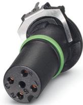
Kontaktträger, 4-polig, Buchse, gerade, M12, A-Kodierung, THR-Lötanschluss, Artikel ist bleifrei nach RoHS II ohne Ausnahme 6c (Pb < 0,1 %)
