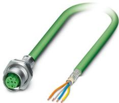
Gerätesteckverbinder Hinterwand, PROFINET CAT5 (100 MBit/s), EtherCAT® CAT5 (100 MBit/s), 4-polig, PVC, grün RAL 6018, geschirmt, Buchse, gerade, M12-SPEEDCON, D-Kodierung, auf freies Leitungsende, Kabelanschluss, Kabellänge: 1 m, PROFINET PVC flexibel CAT5, Artikel ist bleifrei nach RoHS II ohne Ausnahme 6c (Pb < 0,1 %)
